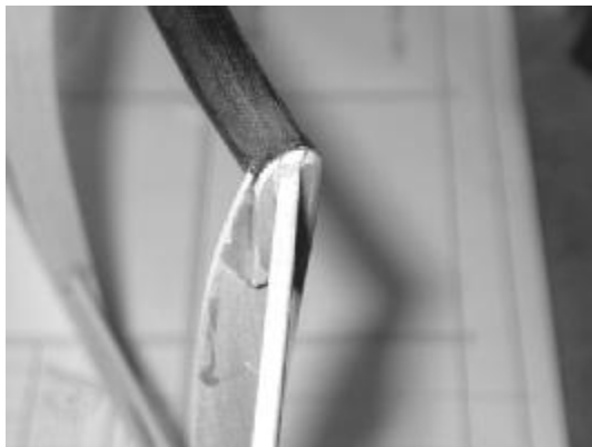
Přechod mezi ústím uhlíkové trubky a lamelou je dobré zaslepit a zbrousit do kulata. Nejprve jej oblepíme kousky balsy a po vytvrzení lepidla opatrně obrousit tak, aby se broušení nedotklo lamel.
