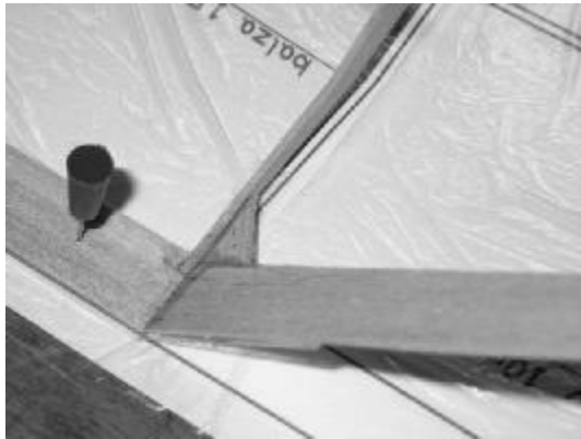
Zesílení spoje ucha u odtokové hrany
